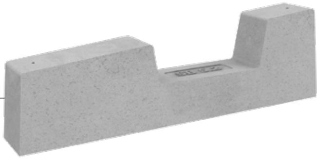
Le système Mono-rangée représente une solution simple et extrêmement polyvalente: disponible avec une large gamme d'inclinaisons de 0° à 30°, les ballasts permettent de fixer les panneaux à la verticale, à l'horizontale ou avec une orientation Est-Ouest, en modulant librement la distance entre les rangées et en garantissant une installation facile et rapide, même en présence d'obstacles.
